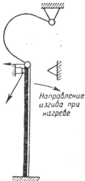
Рис. 14.6. Механизм с «прыгающим» контактом
