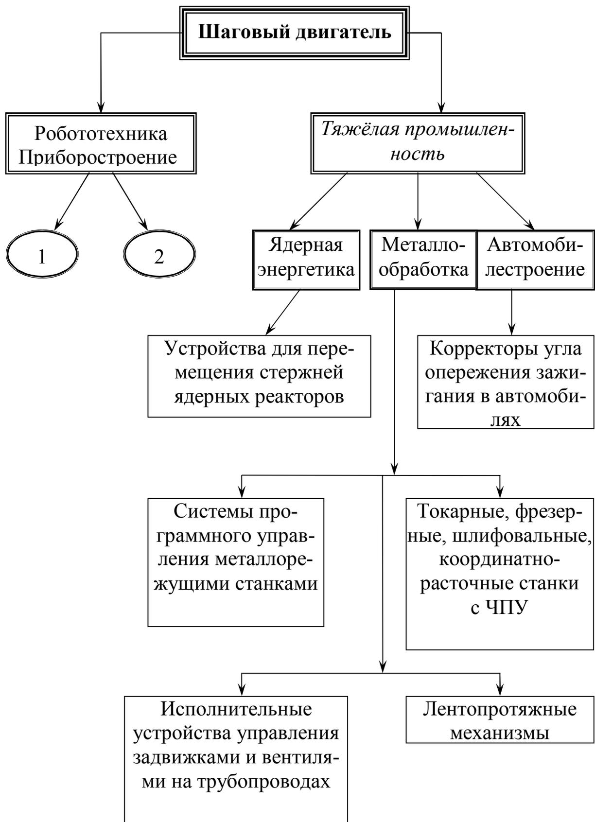
Рис. 14.2. Схема классификации областей применения ШД
