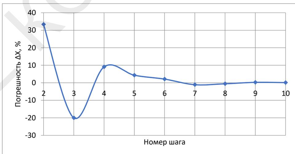
Рис. 4.4. График зависимости погрешности вычисления оптимального значения параметра проектирования от шага поиска
